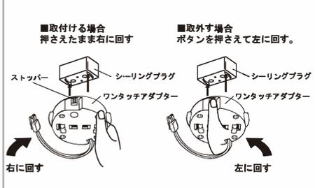
5. ワンタッチアダプターが固定できたら、配線を固定用金具の真ん中を通し、固定用金具を天井まで押し上げます。固定用金具を取付け後、本体に付属しているコネクタとワンタッチアダプターのコネクタを取付けて下さい。コネクタ取付け後本体を天井側へ押し上げ、キャップ穴に固定用ボルトを通して下さい。
