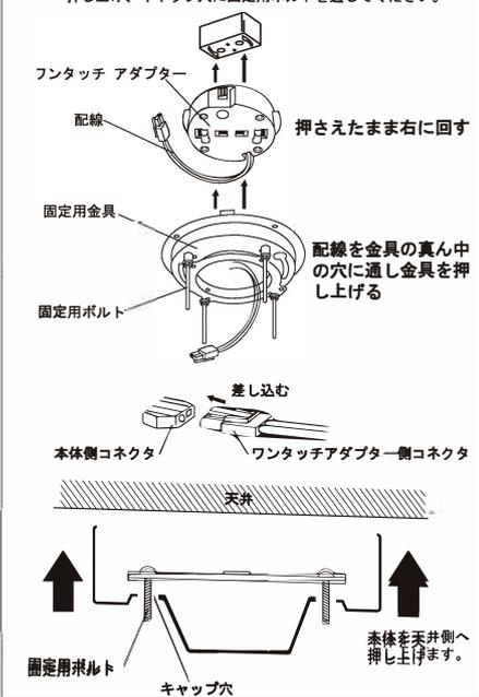
6. 取り外していた4つのキャップ固定用ネジをしっかりと固定用ボルトに締め付けて確実に固定します。
