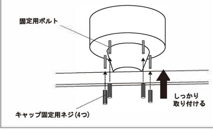
7. キャップが確実に締まり、本製品が固定されましたらお部屋のスイッチを入れ、付属のリモコンで点灯を確認してください。
