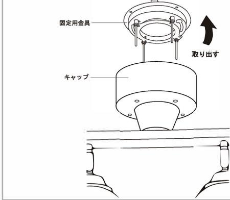
4. 本製品を取付けるお部屋の壁面スイッチの電源をオフして下さい。次に引掛付プラグのストッパーを押さえたまま、天井の配線器具に固定して下さい。
